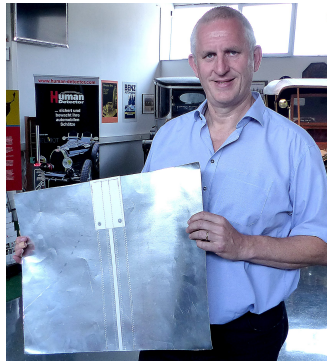
Mit Aluminium beschichtete Sensorfolien werden hinter Bildexponaten eingesetzt.
